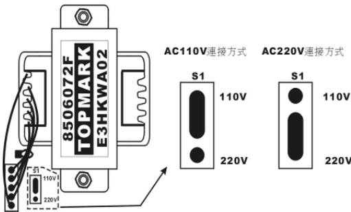
請將機殼上蓋打開後，於變壓器旁有一 JUMPER【S1】，請依所需之輸入電壓將短路 Pin 接至一側即可
